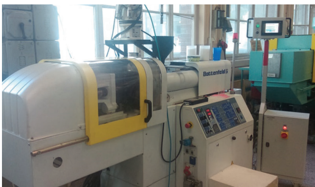
Rys. 2. Wtryskarka ślimakowa wykorzystana do otrzymywania próbek z kompozytów LDPE/talk
