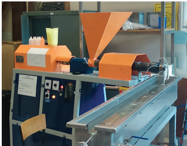
Rys. 1. Wyłaczarka jednoślیمakowa z wanną do chłodzenia wytłoczony
