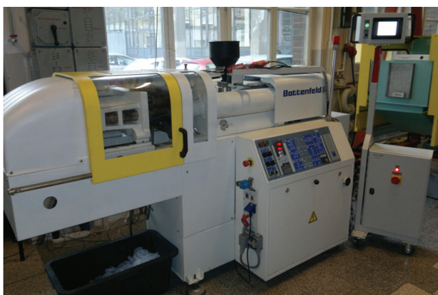
Rys. 2. Wtryskarka ślimakowa Battenfeld PLUS 350/75, wykorzystana do procesu wtryskiwania oraz do pomiarów zapotrzebowania na moc
