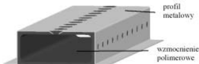
Rys. 6. Element hybrydowy wytworzony techniką Metal-Gaim (wg [6])
