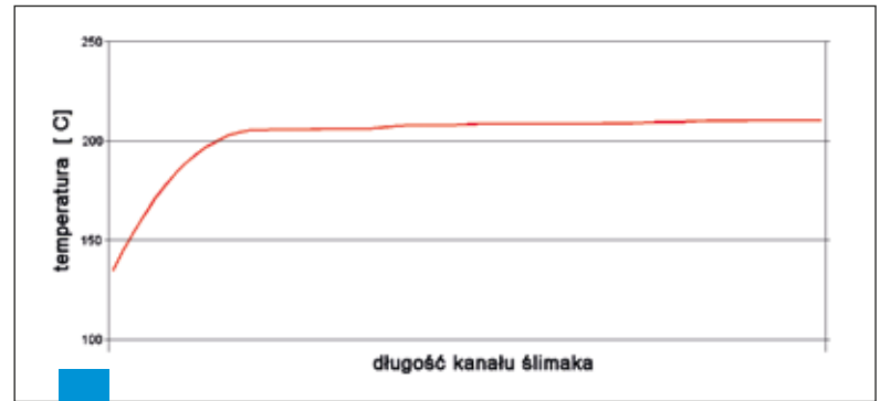
Rys. 11. Przykładowy profil temperatury w procesie uplastycznienia HDPE przy wtryskiwaniu
