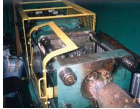
■ Rys. 2. Przykład „atrapy” osłony, która w ogóle nie chroni pracownika przed dostępem do strefy narzędziowej, pomimo że osłona posiada blokadę, która uniemożliwia wykonanie ruchu roboczego przy otwartej osłonie Źródło: R. Charkiewicz, Niebezpieczne wtryskarki, Materiały Okręgowego Inspektoratu Pracy w Białymstoku
