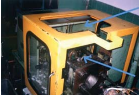
■ Rys. 1. Brak części osłony od góry i od czoła strefy narzędziowej Źródło: R. Charkiewicz, Niebezpieczne wtryskarki, Materiały Okręgowego Inspektoratu Pracy w Białymstoku
