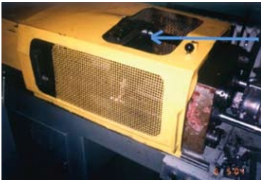
■ Rys. 3. Przykład wtryskarki z otwartą osłoną od góry Źródło: R. Charkiewicz, Niebezpieczne wtryskarki, Materiały Okręgowego Inspektoratu Pracy w Białymstoku
