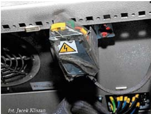
■ Rys. 10. Włacznik krańcowy owinięty taśmą klejącą w celu umożliwienia pracy maszyny przy otwartych osłonach Źródło: Ł. Śmierciak, J. Kliszan, Bezmyślność przyczyną wypadku , Inspektor Pracy, 7-8/2009
