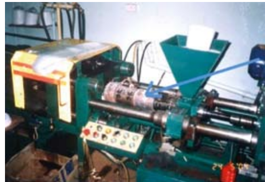
■ Rys. 4. Przykład braku osłon termicznych na cylindrze uplastyczniającym Źródło: R. Charkiewicz, Niebezpieczne wtryskarki, Materiały Okręgowego Inspektoratu Pracy w Białymstoku
