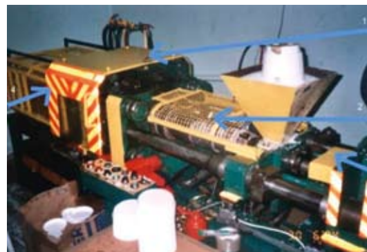
■ Rys. 6. Przykład wtryskarki wykonanej sposobem rzemieślniczym, wyposażonej w osłony miejsc niebezpiecznych Źródło: R. Charkiewicz, Niebezpieczne wtryskarki, Materiały Okręgowego Inspektoratu Pracy w Białymstoku
